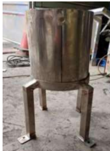
Gambar 5. Assembly rangka dengan dinding tangki
