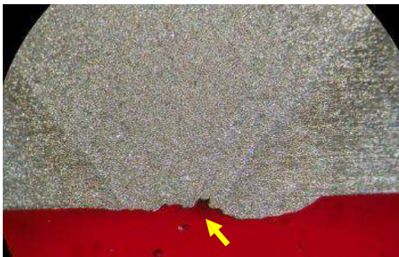
Gambar 7 : Photo makro benda uji sambungan las detail pada daerah rootband dengan perbesaran 12x
