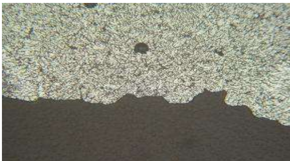
Gambar 13: struktur mikro lokasi 4 area material las (WM) bagian bawah ( rootband ), perbesaran 50 x
