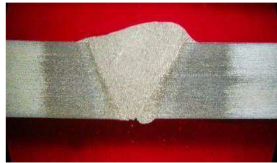
Gambar 6: Benda uji yang dianalisis, dipotong sesuai tanda (garis merah pada gambar 5), photo makro dengan perbesaran 6 x, memperlihatkan bagian rootband, ada bagian yang kurang terisi oleh material las.
