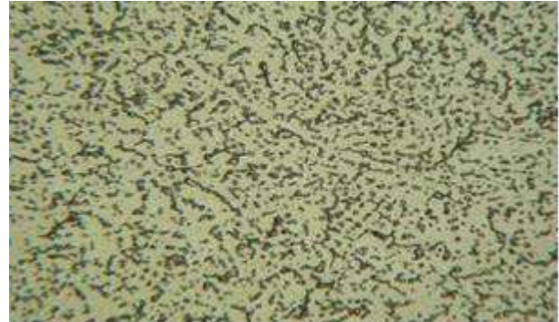
Gambar 12: struktur mikro lokasi 3 area material las (WM) bagian atas ( faceband ), perbesaran 200
