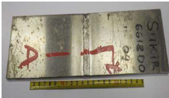
Gambar 5: Lokasi area untuk dijadikan benda uji metallografy (tanda garis merah = arah potongan pengamatan analisis metallografy).
