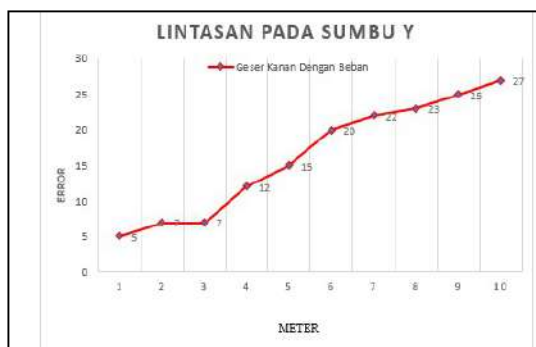
Gambar 3f. Grafik Hasil Pengukuran Sudut Error Terhadap Lintasan (trajectory) Saat Pergerakan Geser Kanan Dengan Beban
