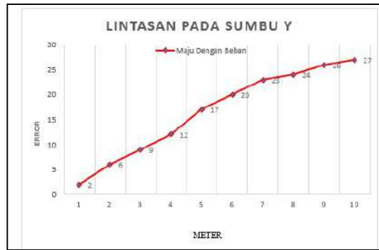
Gambar 3b. Grafik Hasil Pengukuran Sudut Error Terhadap Lintasan (trajectory) Saat Pergerakan Maju Dengan Beban
