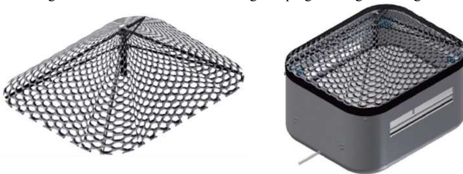
Gambar 27. Rancangan Evaporator Piramida, Wadah Evaporator yang terpasang di Evaporator Piramida
