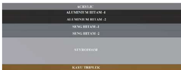
Gambar 29. Lapisan Kolektor Pelat Datar, Gambar 30. Rancangan Kolektor Pelat Datar
