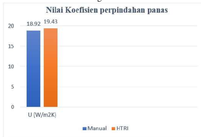
Gambar 5. Diagram perbandingan nilai U perhitungan teoritis dan software HTRI
