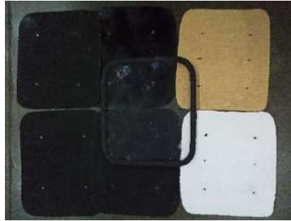
Gambar 4.2. Hasil Akhir Proses Pemotongan & Pengeboran Kolektor Pelat Datar
