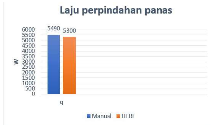
Gambar 6. Diagram perbandingan nilai q perhitungan teoritis dan software HTRI
