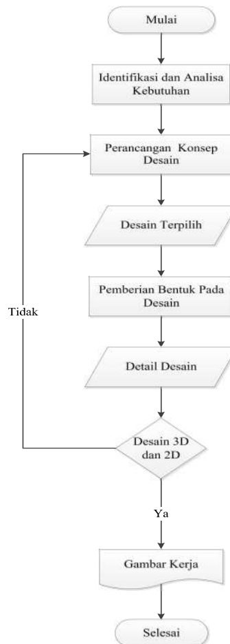
Gambar 1. Diagram Alir Perancangan Reaktor Biodigester. [3]
