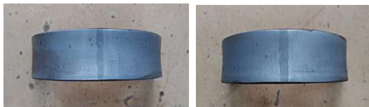
Gambar 8. Hasil Bending Test Spesimen RB 1 dan Hasil Bending Test Spesimen RB 2
