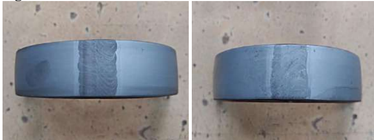
Gambar 7. Hasil Bending Test Spesimen FB 1 dan Hasil Bending Test Spesimen FB 2
