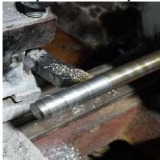
Gambar 3. Proses pembuatan poros
