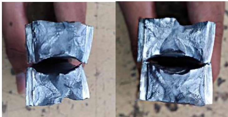
Gambar 9. Hasil Nickbreak Test Spesimen NB 1; (b) Hasil Nickbreak Test Spesimen NB 2
