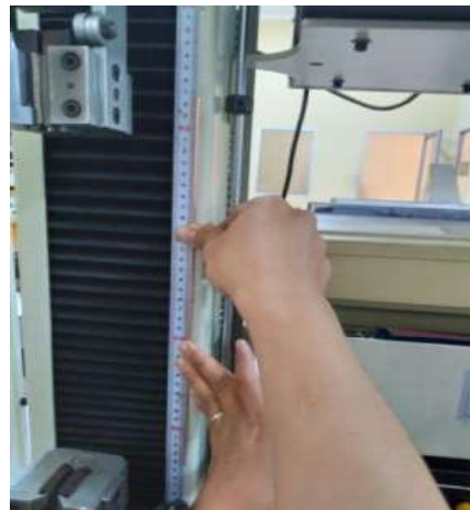
Gambar 3 Proses Pengukuran Elongasi
