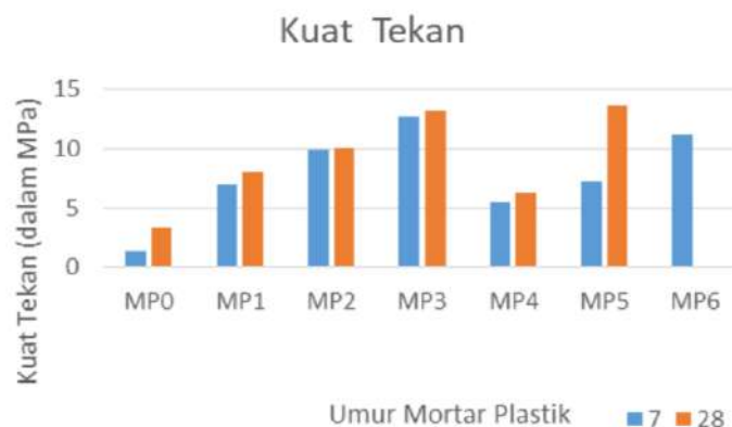
Gambar 3. Hasil Kuat Tekan Mortar Plastik, Fly ash, dan Pasir
