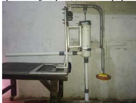
Gambar 10. Prototipe pompa piston aksi tunggal untuk PLTGAL Skala Laboratorium
