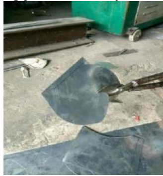
Gambar 5. Proses pemotongan impeller 2
