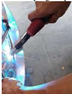
Gambar 9. Proses pengelasan turbin
