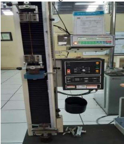
Gambar 2 Proses Uji Tarik
