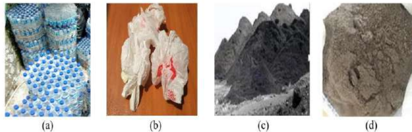
Gambar 1. Material yang digunakan : plastik PET (a), Plastik LDPE (b), Fly Ash (c) dan Pasir silika (d)
