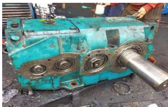
Gambar 2: Gearbox dan poros transmisi untuk pesawat angkut material
