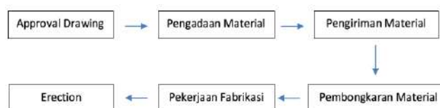
Gambar 5. Alur Pekerjaan Kontruksi baja CSB
