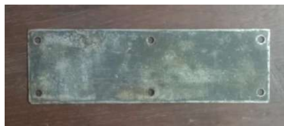
Gambar 6 Alas/Tutup Cetakan ASTM D3039
