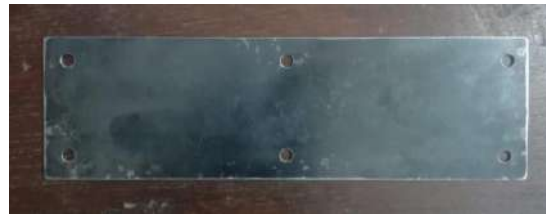
Gambar 11 Alas/Tutup Cetakan ASTM D638
