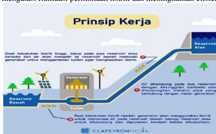
Gambar 3. Prinsip kerja PSH
