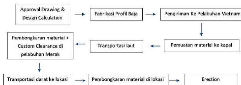
Gambar 4. Alur Pekerjaan Kontruksi baja PEB
