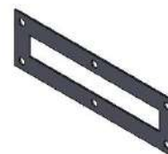
Gambar 2 Desain 3D Cetakan ASTM D3039
