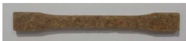
Gambar 16 Spesimen ASTM D638 Sebelum Uji Tarik
