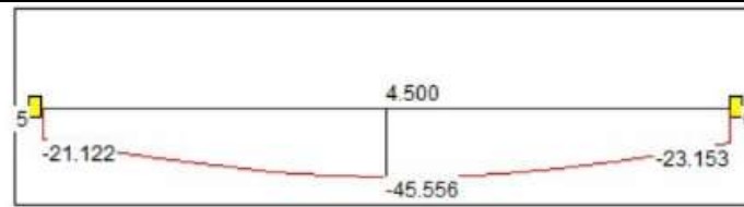
Gambar 8. Lendutan balok dari design calculation PEB
