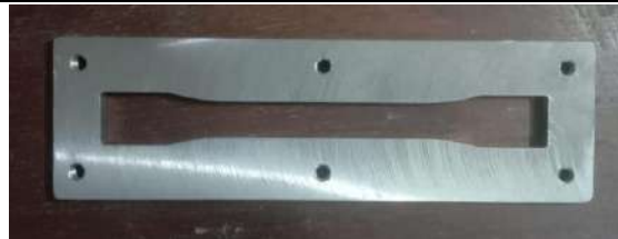
Gambar 10 Detail Ukuran Cetakan ASTM D638
