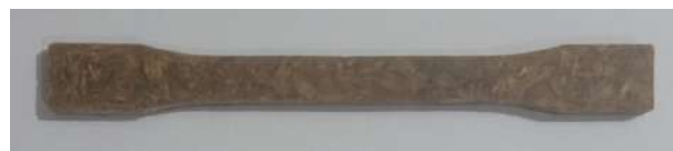
Gambar 15 Komposit Yang Sudah Dilepas Dari Cetakan
