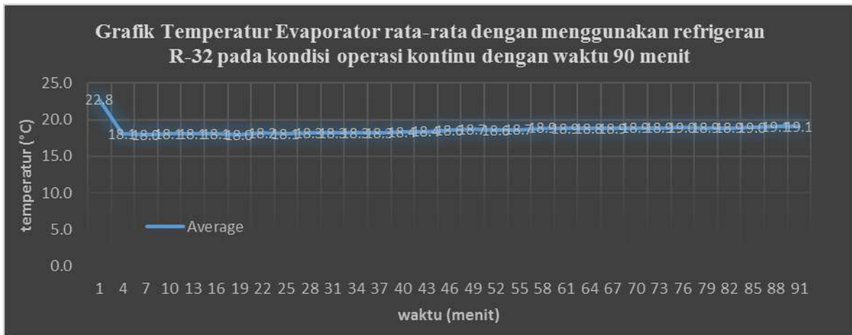
Gambar.3 Grafik hasil rata-rata temperatur udara evap kondisi operasi kontinu refrigeran R-32
