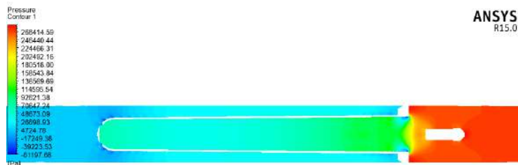
Gambar 13 Plot Tekanan Model Setengah Bola
