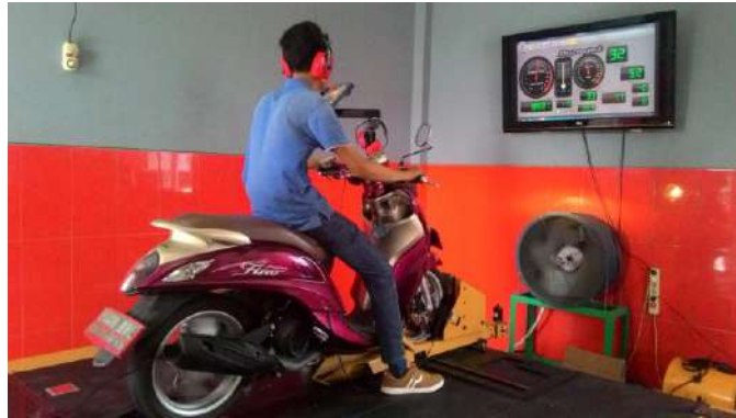
Gambar 3 : Pengujian sepeda motor pada chasis dynamometer
